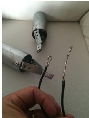
**Figura 11:** Rebite conector-tubo e fio estanhado
